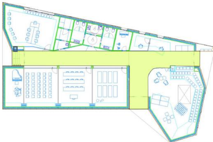
Figura 4. Selección de un grupo de zonas comunes para ejemplificar la zonificación acústica de las mismas.
